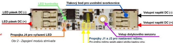
Obr. 2 - Zapojení modulu stmívače
